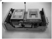
4. HDDブラケットを本製品から持ち上げて取り外します。
